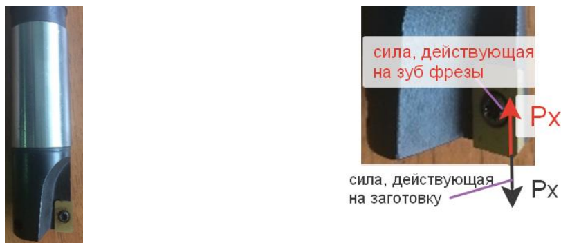
Рисунок 1. Концевая сборная фреза с механическим креплением СМП
