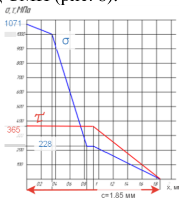
Рисунок 9. Эпюры нормальных \sigma и касательных \tau контактных напряжений (МПа) на передней поверхности СМП при \gamma = +7^\circ , s = 0,52 мм/об ( a = 0,37 мм)
