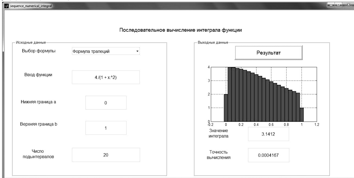
Рисунок 2. Последовательность вычисления интеграла функции методом трапеций
