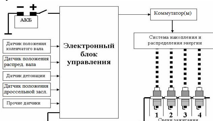
Рисунок 2. Микропроцессорная система зажигания бензиновых двигателей
